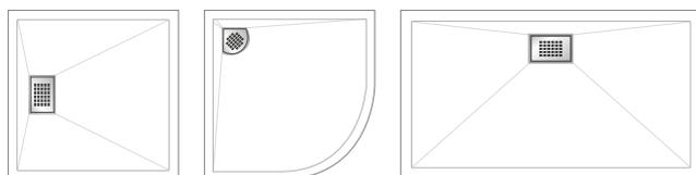
Sur la forme rectangulaire, 2 positions de bonde\* : centrée sur la largeur ou sur la longueur du receveur
